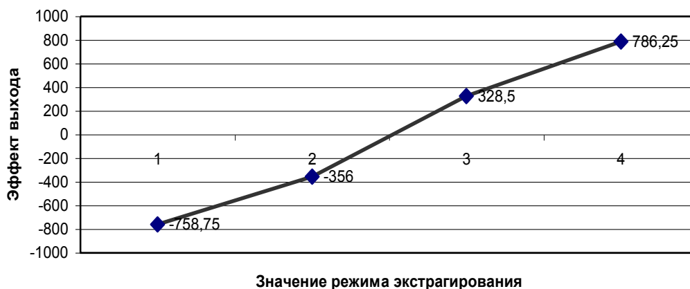
Рис. 1. Влияние температуры на накопление суммы фенольных веществ в экстракте (1 - 20°C; 2 - 35°C; 3 - 50°C; 4 - 65°C)
