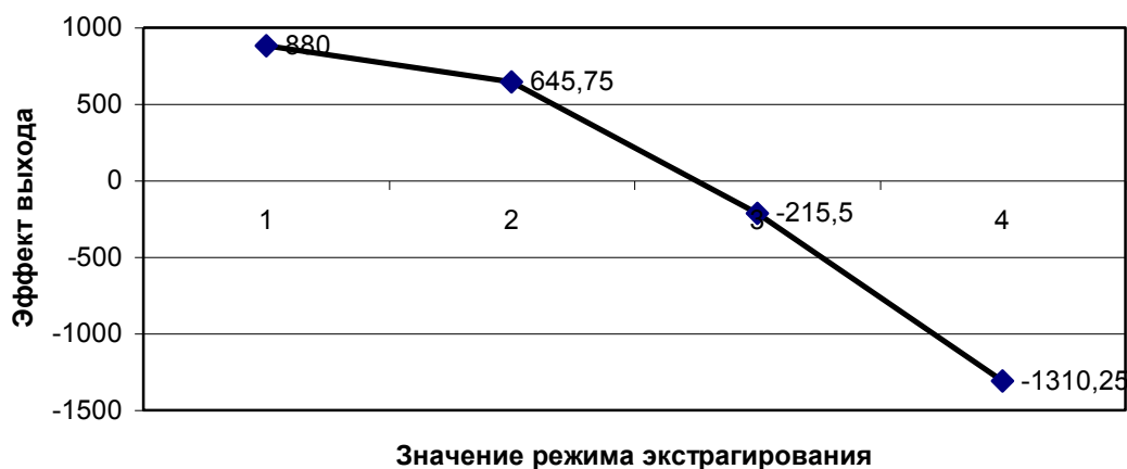
Рис. 3. Влияние гидромодуля на накопление суммы фенольных веществ в экстракте (1 – 3,0; 2 – 5,0; 3 – 7,0; 4 – 9,0)
