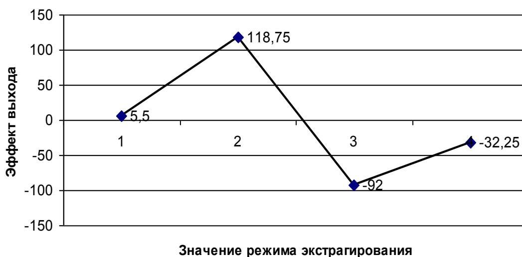
Рис.4. Эффект концентрации этанола на накопление суммы фенольных веществ в экстракте (1 – 40% об., 2 – 50% об., 3 – 60% об., 4 – 70% об.)
